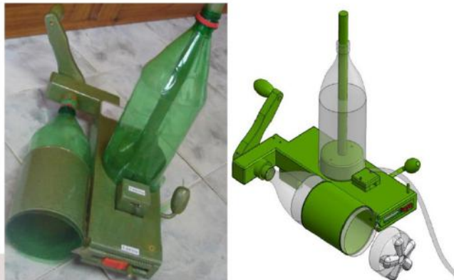
FIGURA 5: Desenho e protótipo do Filetador de garrafas PET. Imagem: Neves et al., (2011)
