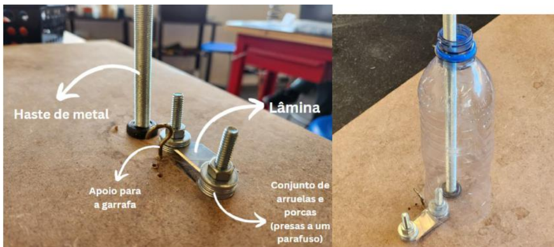
FIGURA 06: Modelo inicial e funcionamento do filetador.
