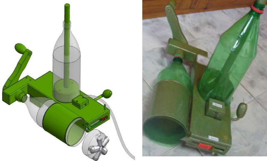
FIGURA 7: Desenho e protótipo do Filetador de garrafas PET. Imagem: Neves et al., (2011)
