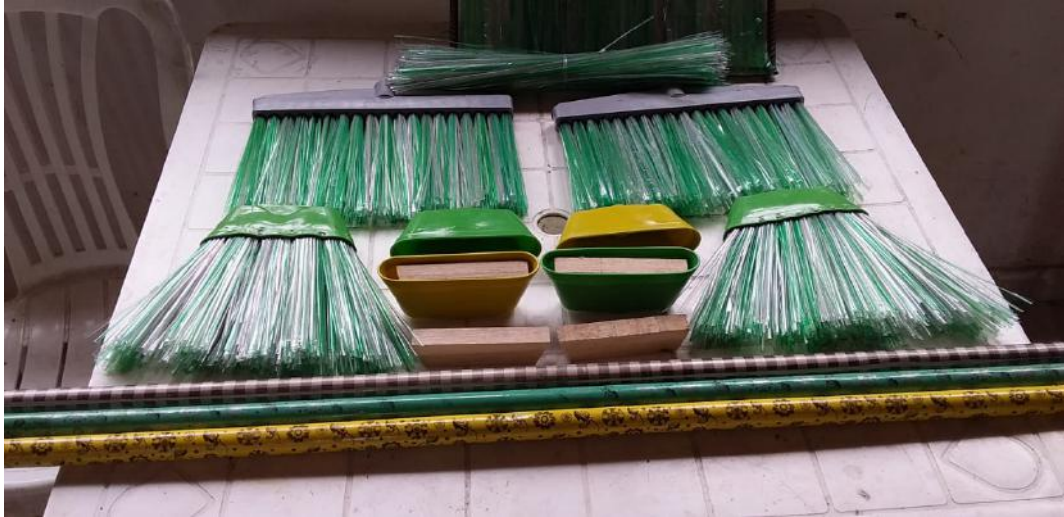
FIGURA 9: Modelos de vassouras criadas com fios de garrafas PET Imagem: Reprodução site: www.vassourapet.com.br , (2024)
