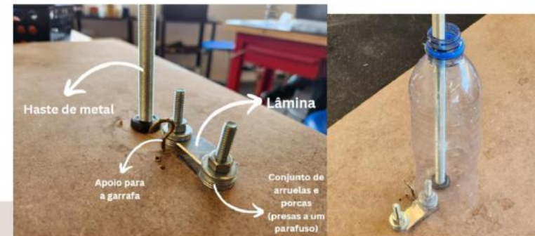
FIGURA 04: Modelo inicial e funcionamento do filetador.
